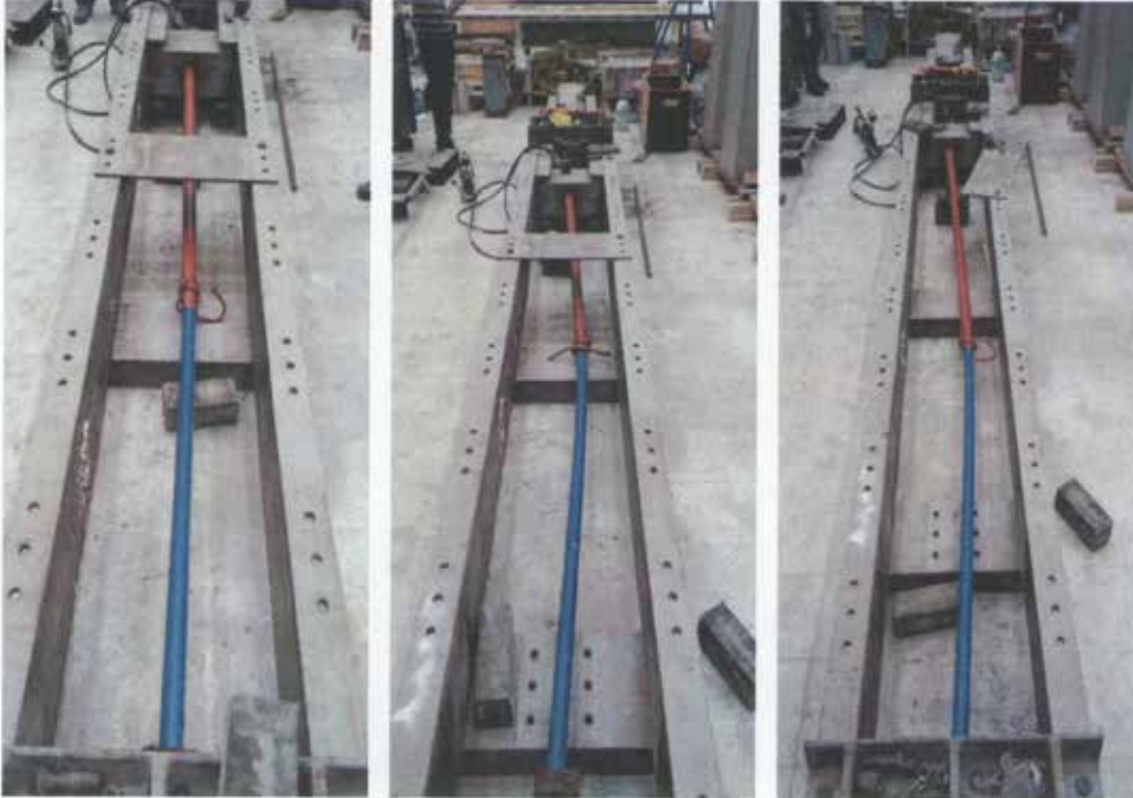
Resim 1. Teleskobik dikmelerin 300cm, 350cm ve 400cm açılma boylarında eksenel yüklemeye deneyleri.
